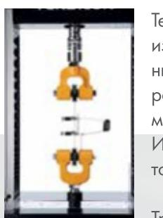
Тензометрическое устройство SG-типа для измерения расстояния между контрольными точками. Устройство для измерения растяжения образцов, характеризующихся маленьким размером и малым весом. Измеряет растяжение между контрольными точками образца.
