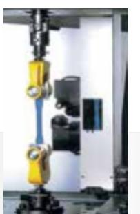
Бесконтактный экстензометр U-4410 для измерения расстояния между контрольными точками. Электронно-оптический -экстензометр с функцией автоматического слежения, с высокой точностью измеряющий растяжение между контрольными точками.
